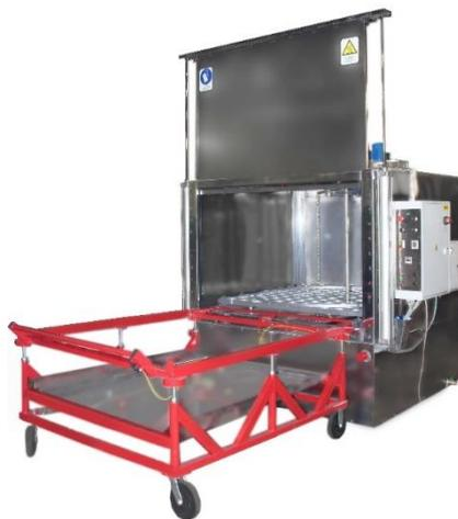
**Серия ЭКО** – автоматические мойки для деталей с откидной крышкой, движущейся корзиной и **струйным приводом**.
