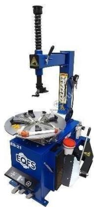
Полуавтоматический шиномонтажный станок ES-21
